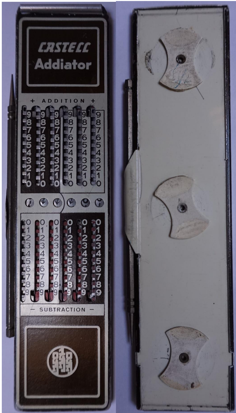
R283 CASTELL-ADDIATOR ohne Rechenschieber Griffel links
